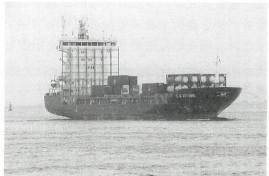
振動での悩みの多いと言われる小型船の細長い居住区
